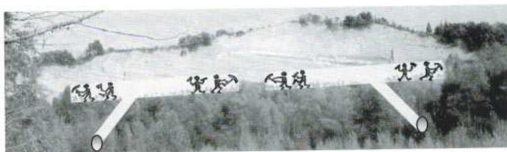
Ricostruzione schematica della modalità di avanzamento dei lavori in cunicolo di quattro squadre di operai, in corrispondenza della massa arenacea del balzo di Prunaroło (foto e disegno di Paolo Michellini)
