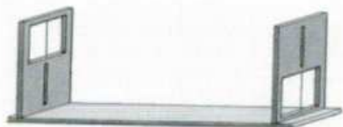
Disegno ricostruttivo di una diottra, utilizzata per tralasciare allineamenti a vista
