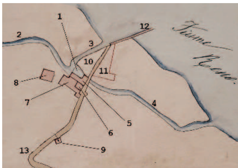
Fig. 2. Mulino "Le Pioppe" nella mappa del 1852 (tratta da Archivio di Stato Bologna, ASB, Canc. Verg. Istanze serie F cat.III n 8077). 1) "botte" del mulino, circa nella stessa località dell'attuale "Botte"; 2) canale con lo stesso percorso dell'attuale canale; 3) scarico del canale; 4) scarico della "Botte"; 5) mulino; 6) bottega; 7) abitazioni e officina; 8) abitazioni; 9) fornace da mattoni; 10 e 11) terreni sui quali nel 1848 Venturi Giuseppe e fratelli, fabbri ferrai nella stessa località, costruirono una ferriera e una ramiera, fabbriche che nel 1853 furono fra i primi acquisti di Antonio Turri; 12) muraglione di sostegno e di protezione; 13) strada pubblica che portava a Cà de Fabbri, poi Termine e Veggio. Al mulino era associata anche la gestione di una Barca per l'attraversamento del fiume.
