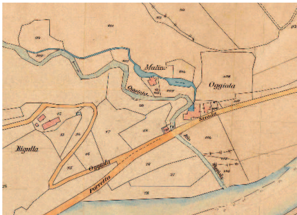
Fig. 5b. Mappa del catasto di primo impianto (1925 circa) nella quale si vede il prolungamento del canale con l'aggiunta di due invasi. Fra l'altro si può notare come il fiume Reno fosse stato notevolmente allontanato dalla strada grazie ai lavori di innalzamento e di deviazione del flusso d'acqua. In queste mappe le strade e le acque sono state evidenziate dall'autore.
