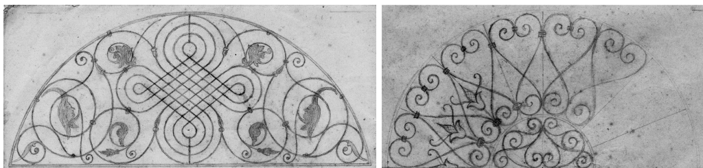
Fig. 6. Due esempi di inferriata per finestra sopra porta a lunetta. Quello di destra è incompleto perchè il lato destro mancante verrà costruito come il sinistro e montato specularmente al primo (proprietà famiglia Mattioli).
