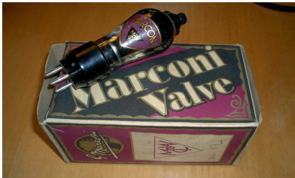
Fig. 7. Foto di una valvola termoionica costruita nello stabilimento di Chelmsford (Londra), frutto dell'invenzione dell'ingegnere britannico Ambrose Fleming (1849-1945), collaboratore di Marconi, che consentiva di trasmettere le oscillazioni della voce umana e quelle della musica (foto Paolo Michelini: valvola esposta nel Museo Marconi di Villa Griffone).
