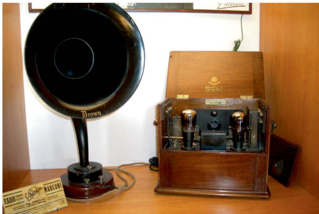
Fig. 8. Ricevitore radio per onde elettromagnetiche con voce umana e musica, realizzato nello stabilimento di Chelmsford (Londra) nel 1923, modello Marconiphone V2A a due valvole (foto Paolo Michelini: radio esposta nel Museo Marconi di Villa Griffone).
