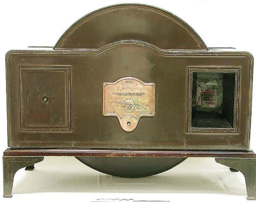
Fig. 9. Ricevitore televisivo a 'disco di Nipkow' presentato dall'inventore scozzese John Baird nel 1925 composto di elementi elettrici e meccanici (esposto nel "Museo scienza e tecnologia" di Milano, tratto dal web: https://artsandculture.google.com/asset/televisore-meccanico-a-disco-di-nipkow-baird-televisor/0wGjdfNb1_-nbg ).
