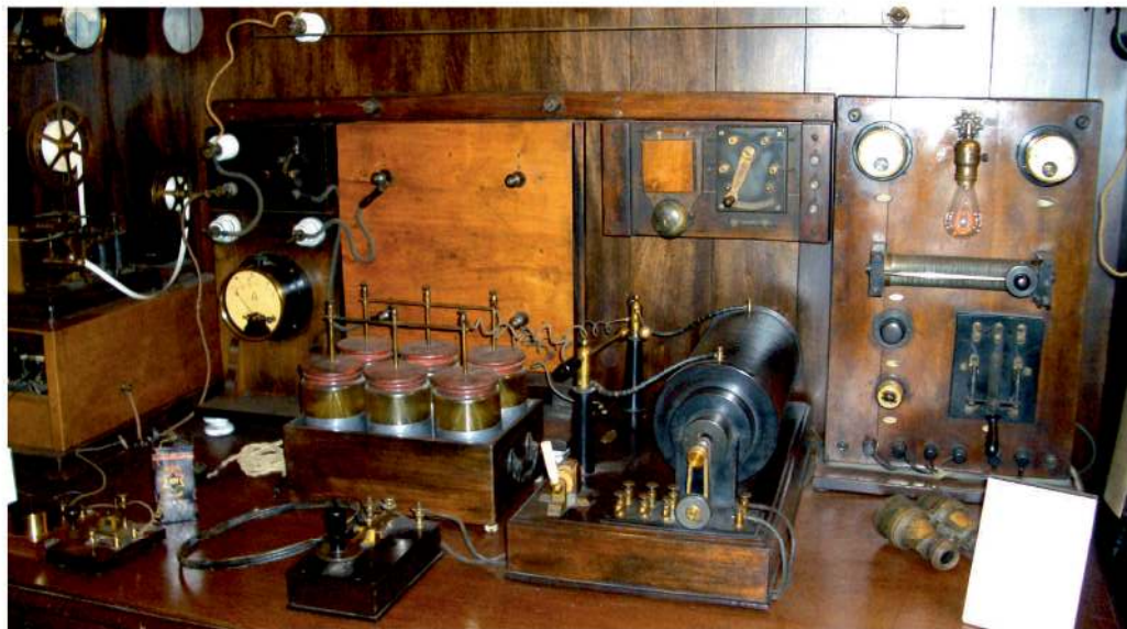
Fig. 5. Stazione ricetrasmittente, prodotta dalla fabbrica inglese della Compagnia Marconi, dello stesso tipo di quella installata sul transatlantico Titanic (replica funzionante, Collezione Maurizio Bigazzi, Museo Marconi; foto Paolo Michelini).
