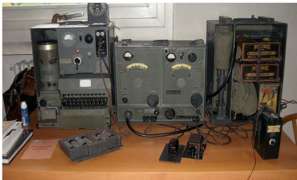
Fig. 9. Stazione radio telescrivente portatile di costruzione tedesca, anno 1944, impiegata durante il secondo conflitto mondiale. La parte sinistra è la stampante, la parte centrale il ricetrasmittente radio, la parte di destra è di alimentazione (Collezione Maurizio Bigazzi, Museo Marconi; foto Francesco Bergamaschi).
