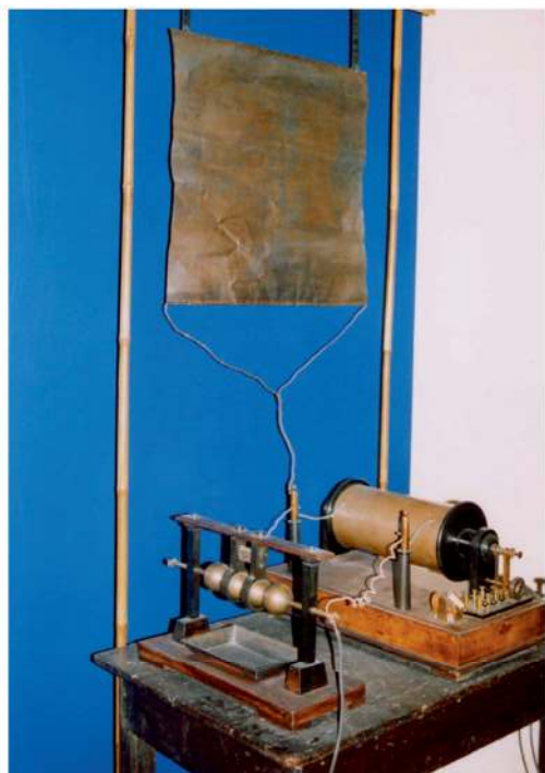
Fig. 4. Oscillatore a scintille con antenna e presa di terra impiegato da Marconi nel 1895 a villa Griffone come trasmettitore per i suoi primi esperimenti di comunicazione telegrafica senza fili (replica funzionante, Collezione Maurizio Bigazzi, Museo Marconi; foto Paolo Michelini).
