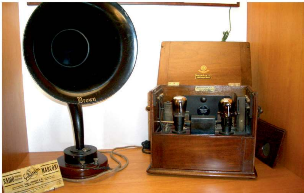
Fig. 6. Apparecchio radiorecettore a valvole costruito dalla fabbrica inglese della Compagnia Marconi nel 1922 (Collezione Maurizio Bigazzi, Museo Marconi; foto Paolo Michelini).
