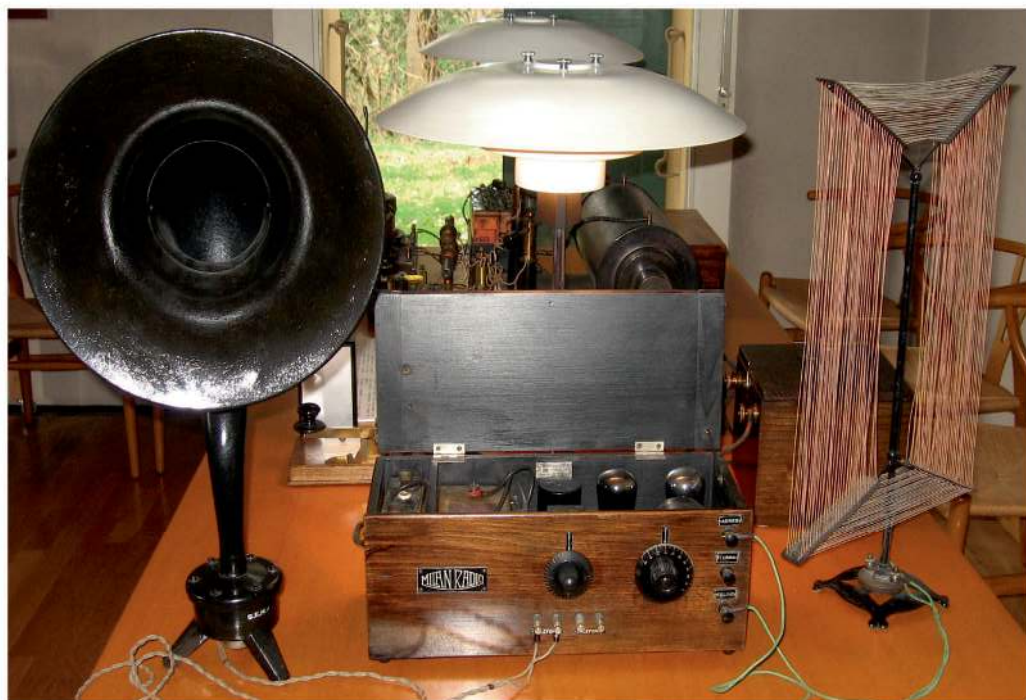
Fig 7. Uno dei primi apparecchi radioricevitori a valvole di costruzione italiana, della MilanRadio, anno 1925 (Collezione Maurizio Bigazzi, Museo Marconi; foto Francesco Bergamaschi).
