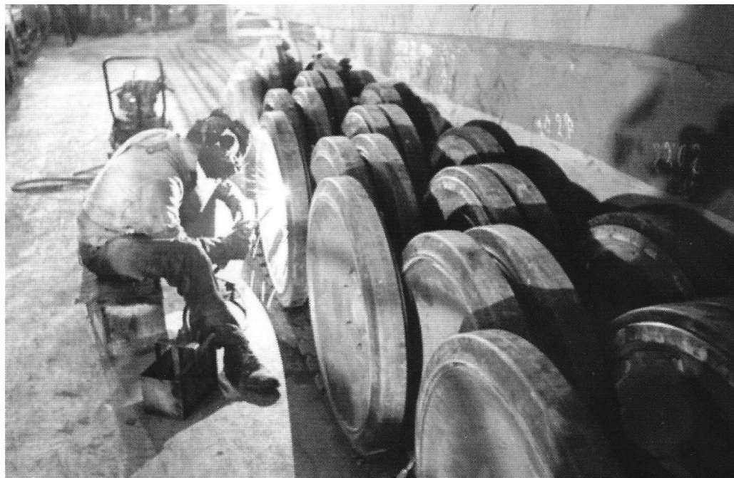
Fig. 8. Il montaggio di ruote per il treno di rotolamento di carro armato Tiger in una fabbrica tedesca.
