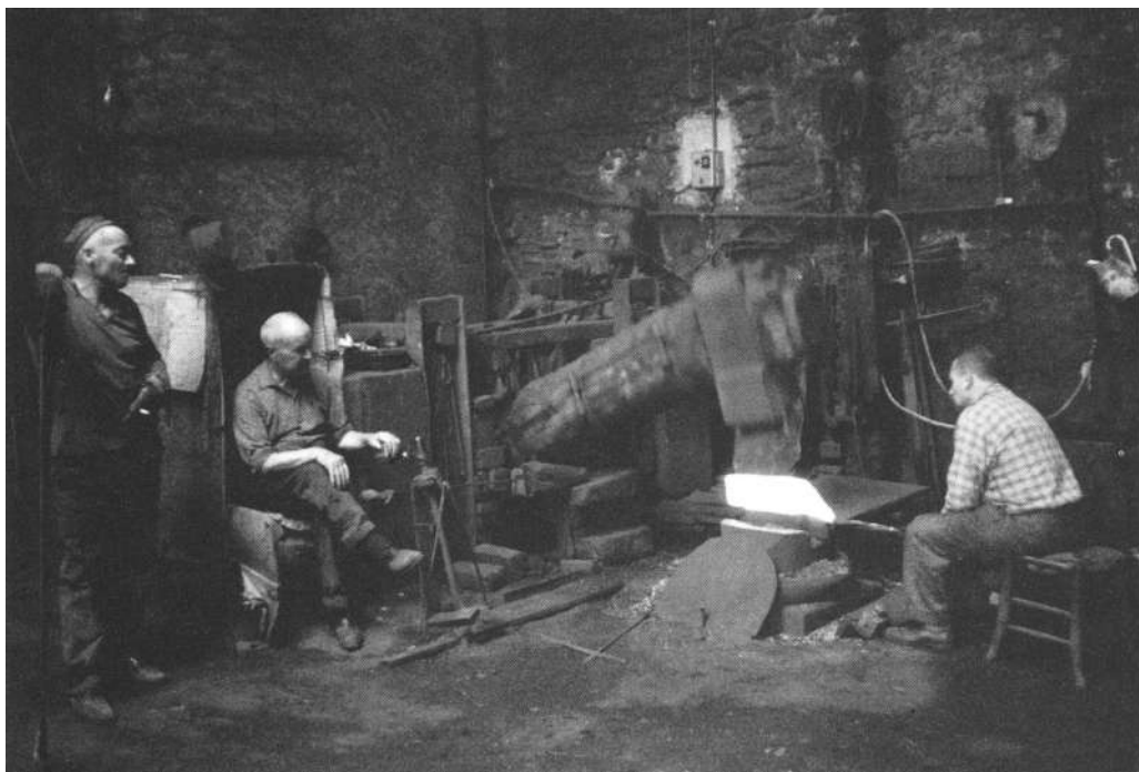
Fig.4. Foto di un "maglio" ancora in uso sino agli anni '70 nell'antica ferriera Lenzi di Silla, nella valle del Reno. Il "maglio" era un grosso martello, azionato dalla forza dell'acqua, usato per battere i metalli (da "C'era Bologna" a cura di T. Costa e O. Tassinari Clò).
