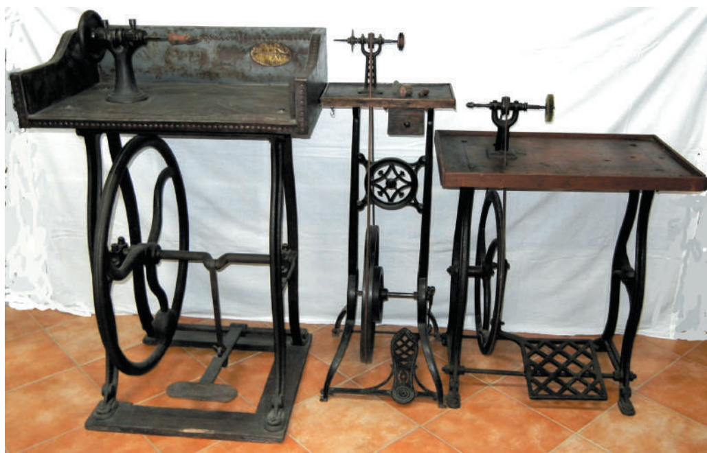
Fig.12. Pulitrici: macchine utilizzate per la finitura e lucidatura del gioiello di oreficeria. Alcune, nel passato, venivano realizzate utilizzando parti di macchine da cucire (foto Brillantino Furlan).
