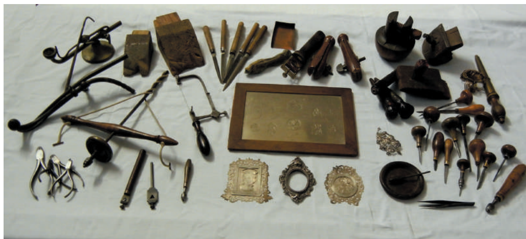
Fig.11. Attrezzi normalmente presenti sul banco dell'orafo. Sulla sinistra è visibile un antico "trapano a volano" che pare sia stato ideato da Leonardo da Vinci (foto Brillantino Furlan).
