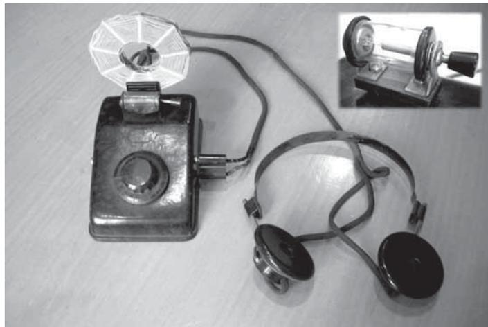
**Fig. 2. La radio a galena (minerale cristallino di solfuro di piombo) ebbe un'ampia diffusione a partire dagli anni Venti del Novecento. Divenne presto popolare per il suo costo accessibile e la semplicità di costruzione, fu chiamata "la radio dei poveri" (foto Paolo Michelini)**
